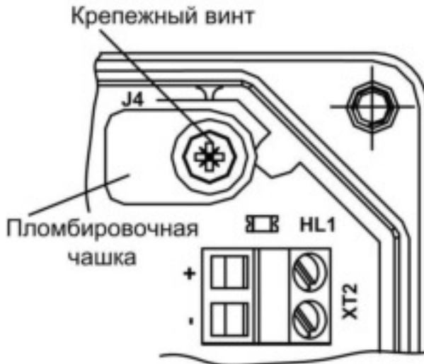
Рис.16. Пломбировка джампера СЕРВИС
